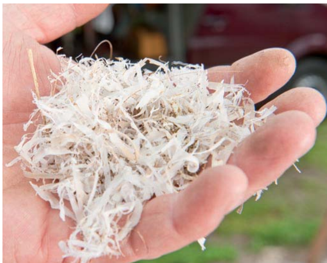
Mecanizado de cuerno con viruta larga gracias al dentado basto.
