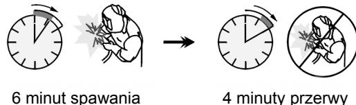
Urządzenie jest zabezpieczone przed nadmiernym nagrzewaniem się uzwojeń transformatora przez ogranicznik temperatury. Uaktywnienie się zabezpieczenia sygnalizowane jest przez zaświecenie się lampki. Po uzyskaniu przez uzwojenia normalnej temperatury pracy następuje samoczynne załączenie urządzenia a lampka gaśnie.
