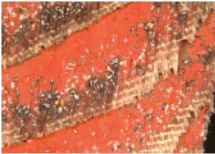
Patrón de desgaste típico con la película de refrigeración brillante característica (no hay "vitrificación").
