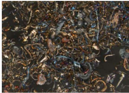
Viruta generada con discos de láminas lijadoras o con discos de desbaste convencionales. Coloración azul por sobrecalentamiento.
